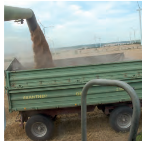
Kleine Straßenreifen am Anhänger mit 8 bar Reifenfülldruck sind ein Bewirtschaftungsfehler. Die falsche Bereifung für den Acker schädigt das Bodenleben und die Ertragskraft.
