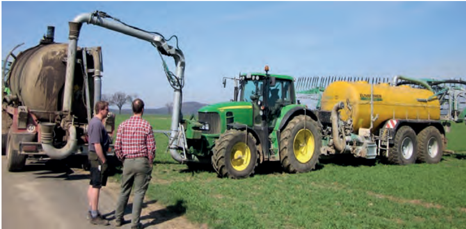
Mit großvolumigen Reifen und variablem Reifendruck fährt dieses Gespann dieselsparend und mit hoher Ausbringleistung.
