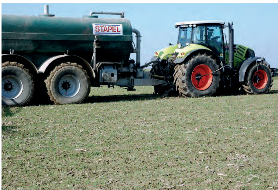
Die ProAir-Reifendruckanlage mit Kompressor ist unter der Abdeckung am Faß montiert, mit dem alle Reifen für die Straßenfahrt gefüllt werden. Traktor und Fass fahren mit ca. 1 bar auf dem Acker.
