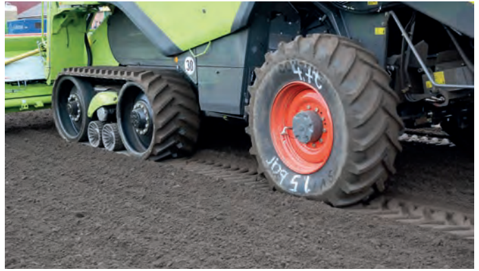
Mit 1,5 bar Reifendruck an der Lenkachse fährt und drischt dieser Raupendrescher bodenschonend. So wird die Spur nicht vertieft und 1,8 Liter Diesel/Std. weniger verbrannt. Fotos: Volk
