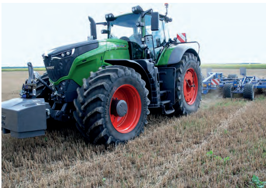
Der 1.000er-Fendt hat serienmäßig VarioGrip, die integrierte Reifendruckanlage. Dadurch fährt er komfortabel und spritsparend auf der Straße und zugkräftig im Acker.
