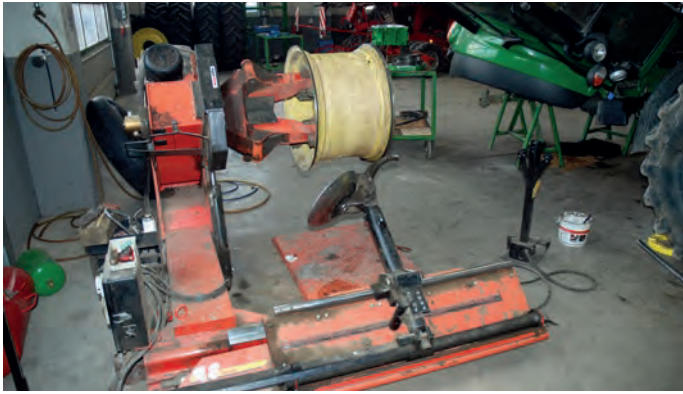
Fachkundige Beratung und die richtige Montagetechnik sind die wichtigsten Kriterien. Neue Felgen sollten geriffelt sein und die Reifen werden mit spezieller Montagepaste montiert.
